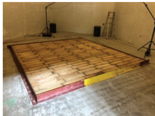
レンガの吸音率測定試験体（大ホール分）
