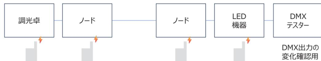
フェーダーにアンテナを接触させると、DMXレベルが3/255程度変化した。明かりの変化でも確認できたが、ムービングのパンチル動作では分かりやすく変化。フェーダーのスリットがあるため、ここから電磁影響を受けていると思われる。
